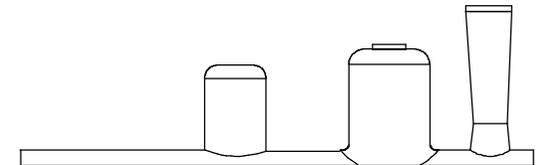
Chaudière, dômes et cheminée sont à réaliser dans de bois dur ou du balsa.
