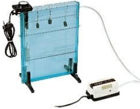
Une graveuse toute simple et ses deux accessoires miraculeux : la pompe à bulles et la résistance chauffante.
