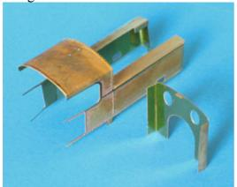
dessoude, on repositionne, on ressoude. Si, comme il convient, vous avez utilisé TRES PEU de soudure, ça ne posera pas de problème. Ensuite, en pressant les pièces l'une contre l'autre, ajustez la façade à la cabine et fixez par de petits filets de soudure dans l'angle, depuis le haut vers le bas, à gauche et à droite. Et vous allez à nouveau vous brûler les doigts. C'est le métier qui entre.
