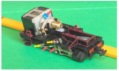
vers l'avant, de l'ensemble phares + toboggan à fraisil. La chaudière en métal moulé et la cabine en plastique s'extraient vers le haut. La cabine est retenue par deux tenons élastiques au niveau des portillons. Les réservoirs cylindriques se décollent facilement → boîte à bidouilles. Les attelages sont bloqués dans leurs logement
