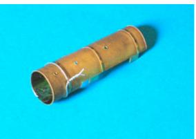
l'arrondi, en particulier pour la partie partiellement amputée qui doit prolonger le cylindre parfait de 12,5 mm de Ø de la boîte à fumée. Une fois la bonne forme obtenue, cerclez la boîte à fumée d'une frette improvisée et soudez la fente inférieure bord sur bord. Très peu de soudure suffit.
