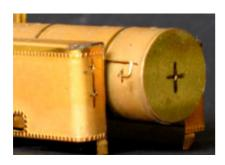
Mon schéma suggère qu'il y aurait deux tringles de commande pour le réglage de l'échappement, une de chaque côté! Ça me paraît beaucoup. Il doit y en avoir une seule, mettons à droite. Il suffit de la poser à plat sur le support de chaudière où elle pourra être collée, trois coudes, un trou dans la boîte à fumée, et voilà.
