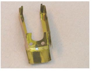
Contrôlez que les tenons de votre pièce mise en forme entrent correctement dans les fentes du tablier, mais ne soudez pas encore ces deux pièces.
