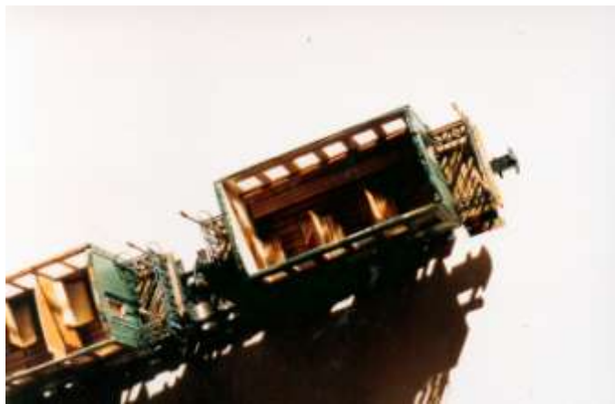
TRAMWAYS DE L'AUDE Vue de l'intérieur aménagement réalisé en contre plaqué de 0.3mm
