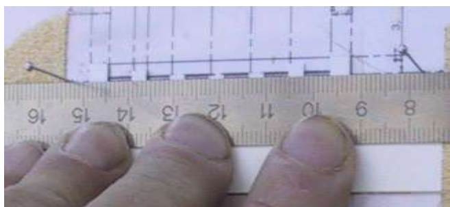
Photo 8 en maintenant le reglet contre les épingles ...
