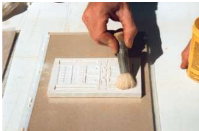
Photo 33 Avant de tirer les épreuves il faut à chaque fois passer un peu de talc sur le moule (agent de démoulage)
