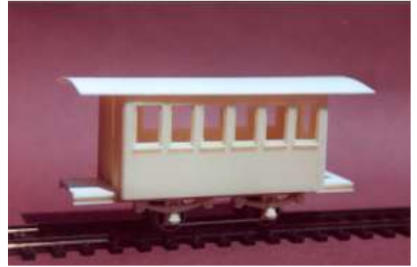
Photo 50 la voiture presque finie le toit ici thermo-formé sera plus tard raidi par deux petits profilés en bois de 1 x 1 collés
