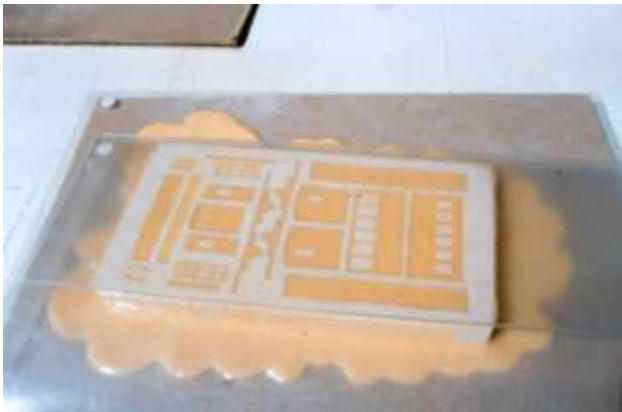
Photo 39 après durcissement environ 20 mn on enlève le poids et l'on peut remarquer le changement de couleur de la résine et le bon remplissage du moule
