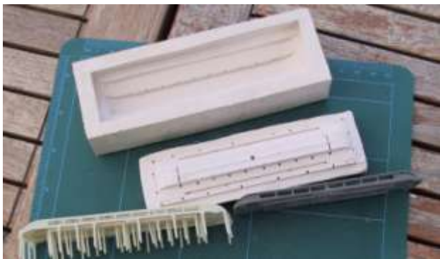
Photo 53 moule modèle et tirage avec encore tous les événements
