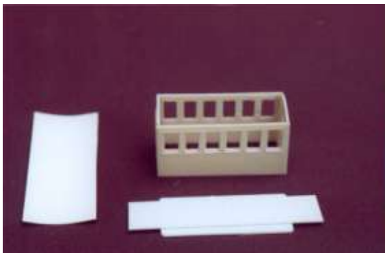
Photo 45 la caisse est montée le toit est thermo-formé et le châssis est ici réalisé avec deux feuille de PS collées
