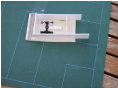
Photo 29 le moule des bogies
