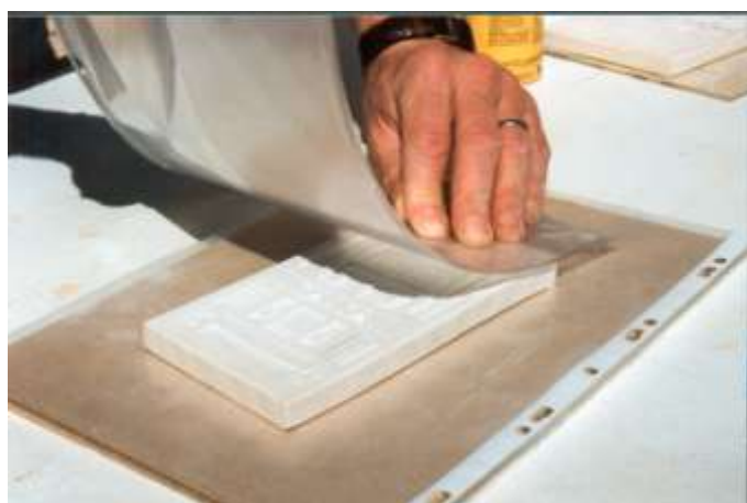
Photo 36 le geste le plus important : il permet de bien remplir le moule il est nécessaire d'utiliser un plexi très souple et recouvert d'une pochette transparente ou de cirer avec un agent démoulant la surface de contact
