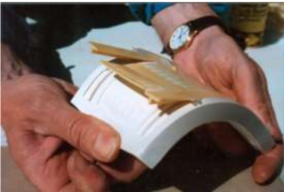
Photo 40 pour démouler il suffit de tordre le moule
