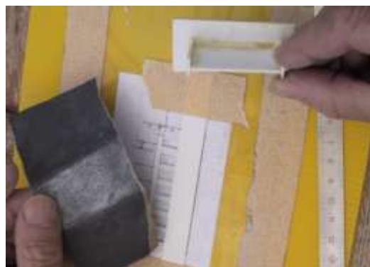
Photo 13 après séchage nous allons poncer cette couche en nous aidant d'une cale
