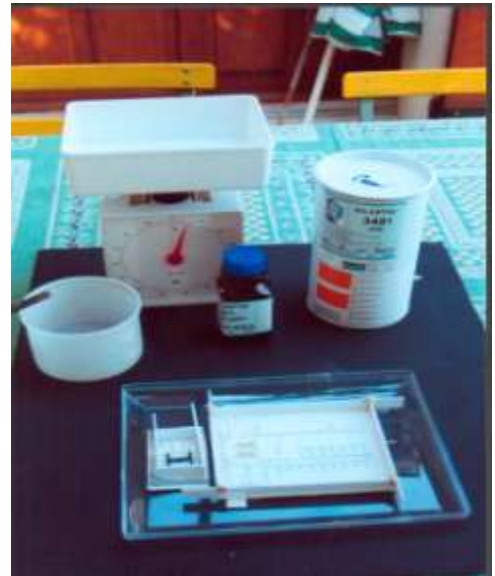
Photo 28 le poste de préparation des produits La balance sert à quantifier la matière à préparer
