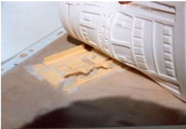
Photo 41 pour les pièces fragiles il faut plaquer le tirage sur un plan et décoller le moule
