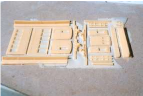
Photo 42 le tirage obtenu les pièces sont maintenues par une légère bavure
