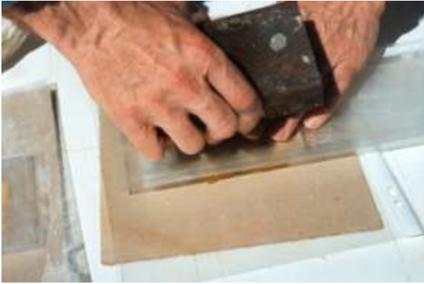
Photo 38 tout en maintenant une pression avec la main on applique un poids ici environ 3 kg
