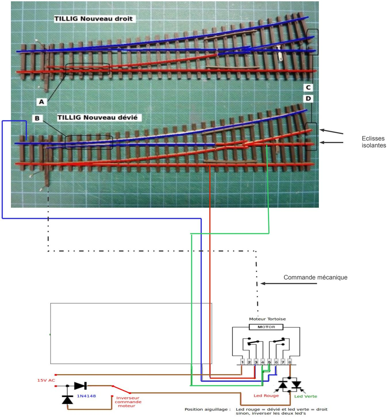
Avant cablage des pins 3, 4, 5, 6
