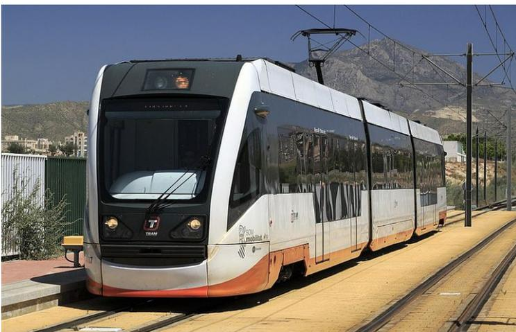
*Le train-tram corse devra être **métrique, électrique ou bimode, moderne, léger et nerveux, typé transport du quotidien et non touristique**, et à plancher bas partiel, au niveau des portes – plancher haut au niveau des roues pour intégrer une suspension efficace.*
