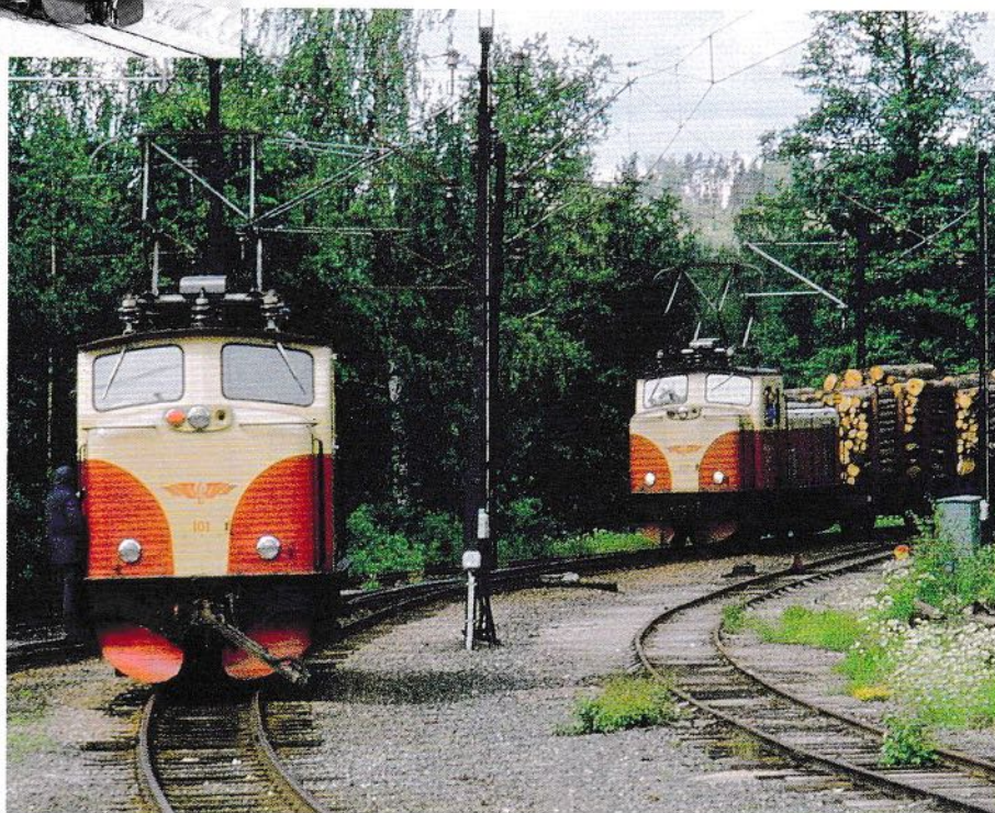
I Deje väntade ASJ-lok 101 HAGFORS vid infartsväxeln på att tågspåret skulle bli fritt efter det passerande virkeståget så att det kunde göra rundgång. Som framgår av stångkopplet på loket förbereddes ytterligare ett tåg med överföringsvagnar vid överföringsrampen, som låg i andra änden av bangården. HAGFORS var det första av de nya loken som ASJ och ASEA levererade år 1961. Fotodatum: 6 juni 1978
